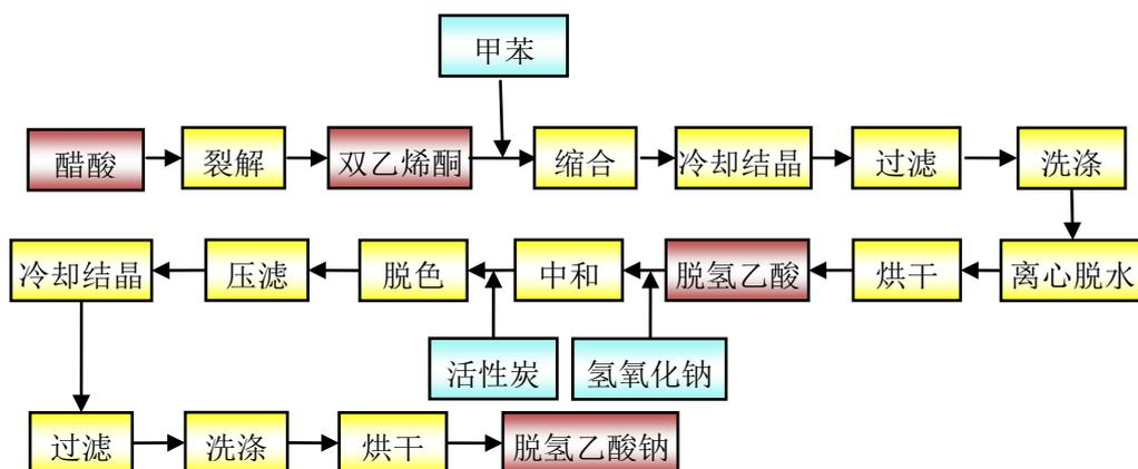
3、乙酰乙酸甲（乙）酯的工艺流程
